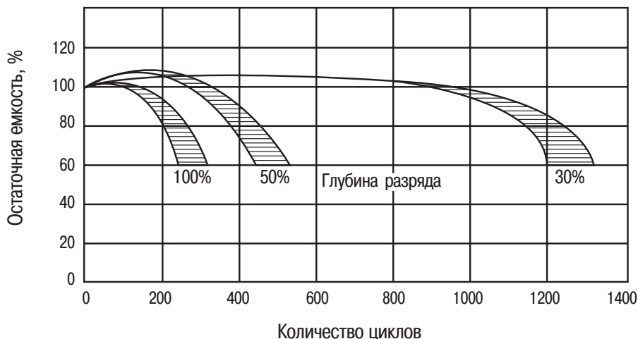
Рис. 11 Зависимость количества циклов от глубины разряда аккумуляторов Ventura.
